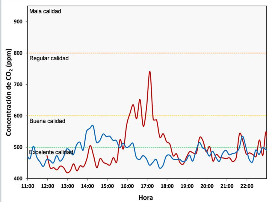
Figura 4. Resultados del monitoreo de CO<sub>2</sub> en un consultorio de 10.5 m<sup>2</sup> de superficie con una puerta de 1.7 m<sup>2</sup>.
