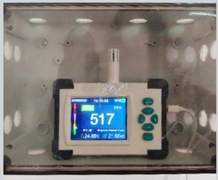
Figura 1. Sensores de concentración de CO<sub>2</sub> instalados en un expendio y en un salón escolar
