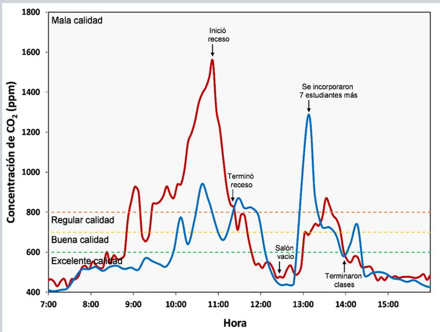
Figura 3. Resultados del monitoreo de CO<sub>2</sub> de dos miércoles en un salón escolar con 80 m<sup>2</sup> de superficie, con una puerta de 1.8 m<sup>2</sup> y una ventana de 1 m<sup>2</sup>.
