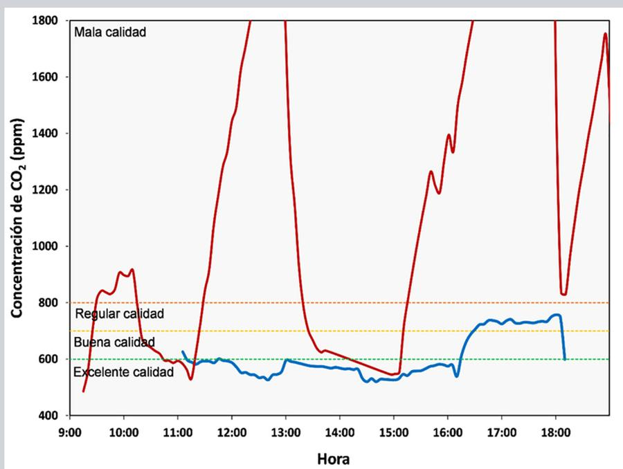
Figura 2. Resultados del monitoreo de CO<sub>2</sub> en un expendio de 40 m<sup>2</sup> de superficie, con una puerta de 4 m<sup>2</sup> y un ventilador de techo.
